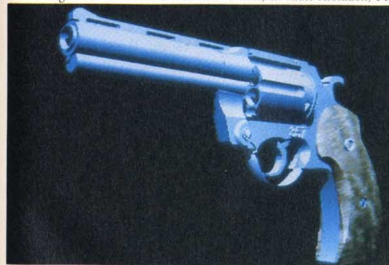
L'arme ! Calculée en HAM (4096 couleurs), résolution 320x512. Cet objet a été modélisé entièrement avec la version pro de Real 3D sur un Amiga 2000 standard, sans que le manque de carte accélératrice se fasse ressentir cruellement. Pour l'animation et la représentation WireFrame, c'est quand même indispensable.
